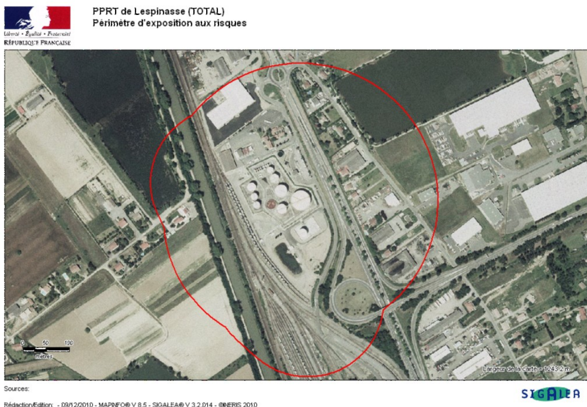
Figure.10. Cartographie du périmètre d'exposition aux risques en considérant le changement d'affectation du bac B (distillats au lieu de supercarburants) et création d'un bac X2 dans la rétention X3 pour stocker les supercarburants en remplacement ainsi que deux autres bacs plus petits Y et Z
